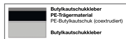
Aufbau DENSOLEN®-N60 und DENSOLEN®-S20 (Dicken unterschiedlich)
