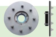
**Ringraumdichtung mit Fest-Losflansch 4 pipes** mit integrierter Fest-Losflanschkonstruktion binden die durchstoßene Dichtungsbahn einer Gebäudeabdichtung sicher in die Mauerdurchführung ein und dichten diese sicher ab. Die Bauweise entspricht der DIN 18533 für Bauten mit Dichtungsbahnen gegen „drückendes Wasser“ (W2-E) alternativ gegen „nicht drückendes Wasser“ (W1-E, W3-E). Inkl. Schrauben und Dübel zur Befestigung
