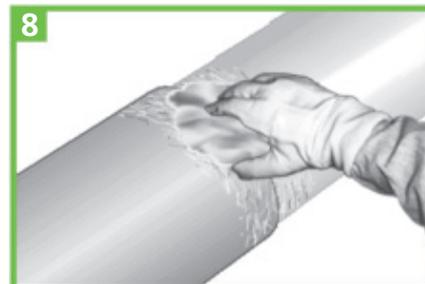
**Entfettung** der Abdichtungsfläche mit PE-Reiniger resp. Ethanol/Spiritus (min. 94%) und einem trockenen, fett- und flusenfreien, nicht färbenden Lappen.
