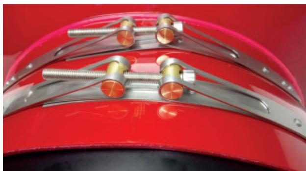
**Angezogene Gelenkbolzenspannbänder mit schweißpunktfreier TOX-Verbindungstechnik. (Bei 4 pipes gefertigt; für Rohrdimensionen  $\geq$  DN 300) Anzugsdrehmoment der Schraube 10 Nm**
