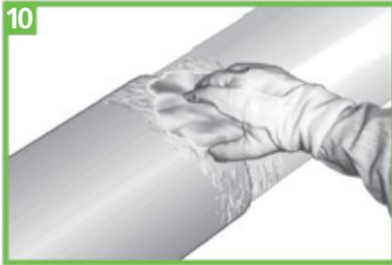
Schlussreinigung der Abdichtungsfläche zur Entfernung der losen, durch die Aufrauung entstandenen HDPE- und Sand-Partikel mit einem trockenen, fett- und flusenfreien Lappen.
