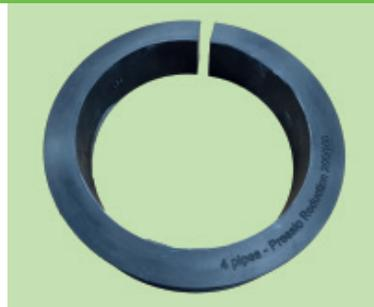
Passenden Gummiring für den gewünschten Durchmesser des Mediumrohrs auswählen und in den Innendurchmesser der Dichtung einlegen. Bei nachträglicher Montage (Typ BlackLine) kann der Einsatz bauseits mit einem Messer geteilt werden.
