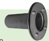
**Mauerhülse mit Fest-Losflansch 4 pipes** mit integrierter Fest-Losflanschkonstruktion binden die durchstoßene Dichtungsbahn einer Gebäudeabdichtung sicher in die Mauerdurchführung ein und dichten diese sicher ab. Die Bauweise entspricht der DIN 18533 für Bauten mit Dichtungsbahnen gegen „drückendes Wasser“ (W2-E) alternativ gegen „nicht drückendes Wasser“ (W1-E, W3-E).
