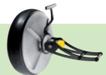
**Aqua Camstopper „PRO“ Rohrverschlussstopfen** mit Excentertechnik und Prüfdurchlass dienen hauptsächlich der **Abdichtung von offenen Rohrenden** an Rohrleitungen aller Art. Aqua Camstopper „PRO“ Rohrverschlussstopfen können auch für **Druckprüfungen** mit Wasser oder Luft, eine Inspektion, zum Spülen oder eine Reparatur eingesetzt werden. Der Aqua Camstopper „PRO“ besteht aus einer EPDM Dichtung, Aluminiumguss Druckplatte und einem Griff aus Stahl mit Epoxydbeschichtung.
