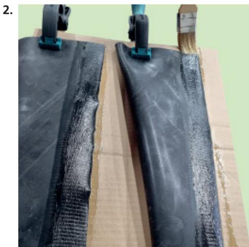
Die Klebeflächen (Breite jeweils ca. 30mm) werden mittels beiliegendem Kleber dünn eingestrichen. Der Kleber benötigt ca. 10 – 15 Min. Trocknungszeit. Sicher in der Beurteilung der Trockenzeit ist der Fingertest: Der Kleber muss sich dabei trocken aber noch klebrig anfühlen.
