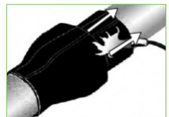
Bei Konturen wie z.B. Muffenverbindungen wird **zuerst auf die Muffe und dann auf das Spitzende** geschumpft. **Die Manschette** und der Verschlussstreifen können während der Montage **mit der Hand an eventuelle Konturen ange-drückt werden**.
