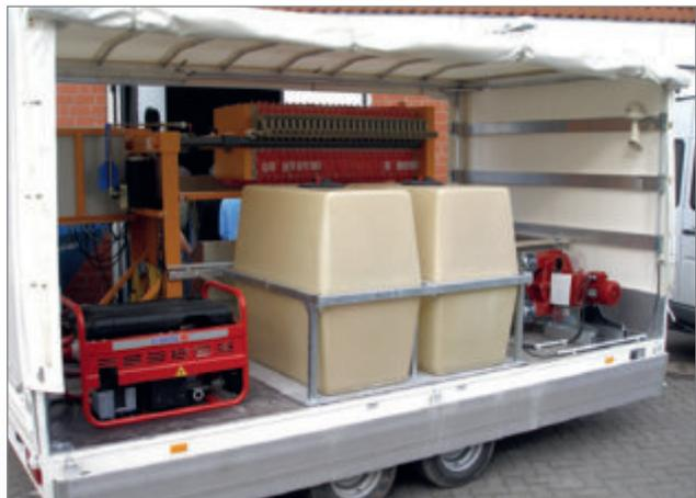
Von links: Stromerzeuger, Klarwassertanks, Schlamm-pumpe
