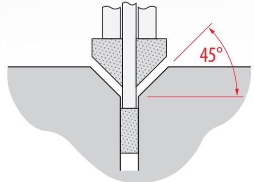
Paarweiser Einsatz mit einer 180 mm Führungsscheibe bei Ø 130 und 150 mm
