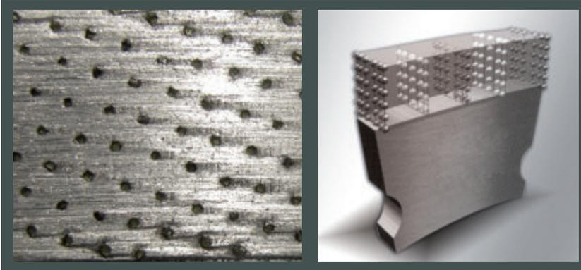
Diamantsegmente mit gesetzten Diamanten der 3. Generation in einem neuem Anordnungsverfahren. Durch die geometrisch exakte Verteilung sind immer annähernd gleich viele Schneiddiamanten im Eingriff. Das garantiert ein exzellentes Schneiden mit sehr hoher Schnittgeschwindigkeit.
