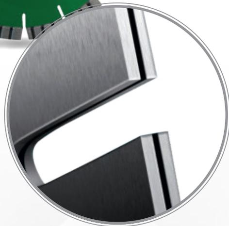
Der Sandwichkern besteht aus drei Lagen, zwei äußeren Stahllagen und einer inneren vollflächig verbundenen Metallfolie. Durch diesen Aufbau wird die Übertragung der Schwingungen auf ein Minimum begrenzt.
