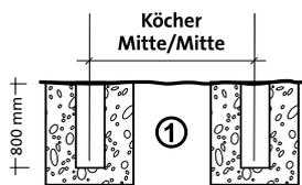
Fertiggestelltes, abgebundenes Köcherfundament aus Beton C20/25.
