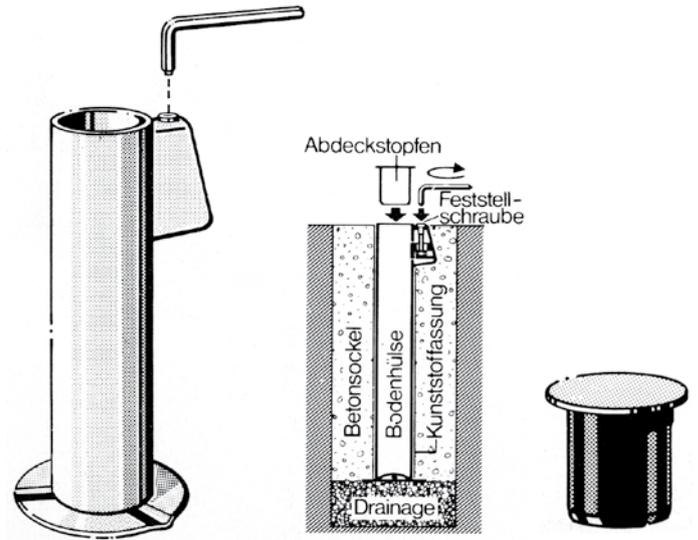
**Bodenhülsen aus Grauguss GG20 mit Gewinding und Nylon-Klemmring**
