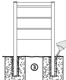
Zwischenraum Säule/Leerrohr wird mit feinem Quarzsand ausgefüllt, jede Seite zur Hälfte, dann nochmal ausrichten.
