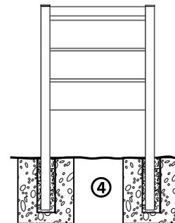
Aufsteller kann im komplett montierten Zustand nicht mehr entfernt werden. Vor Ort auseinandergeschraubt ist ein „Ziehen“ der Schildpfosten jedoch möglich (Umsetzen).
