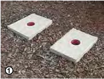
In der Praxis bestens bewährt haben sich **Köcherfundamente mit Leerrohren** ①. An Stelle der Schildpfosten wird ein im Durchmesser größeres Leerrohr aus Kunststoff einbetoniert (Baumarktabflußrohr).
