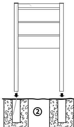
Fertig montiertes Schild wird in die Leerrohre gestellt und ausgerichtet.
