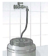
Entleeren der Leitung in den Auffangbehälter
