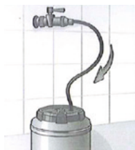
Entlüften der Leitung
